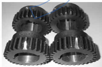
图5 太阳轮缺齿损伤验证
