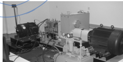
图 3 直升机传动系统故障模拟试验台
